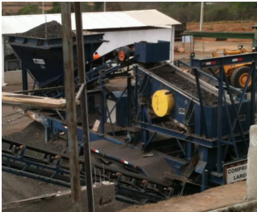
Usina de produção do material reciclado com emulsão
