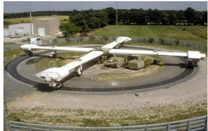
Simulador tipo MLS – África do Sul – Fonte: TRB, 2014
