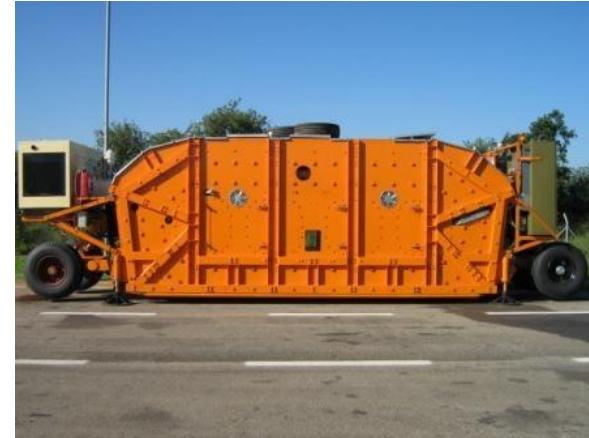
Simulador tipo MLS – África do Sul – Fonte: TRB, 2014
