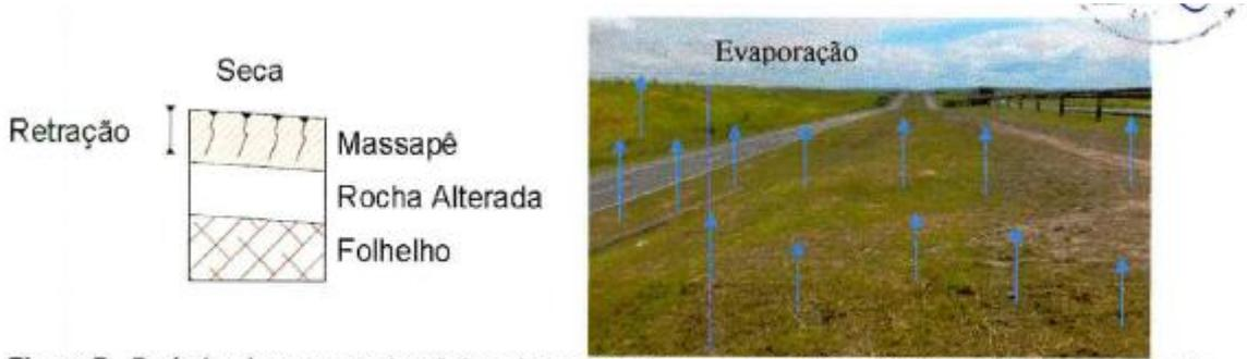
**Figura 7 - Período chuvoso em local de solos expansivos – absorção de água pelo solo, e expansão significativa, afetando a rodovia**
