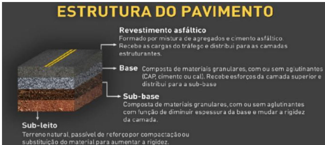
Figura 1 - Ilustração das camadas do pavimento
