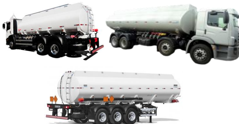
Figura 52 - Implementos rodoviários mais usados na distribuição de combustíveis Truck (3 eixos – PBTC: 23 t) Truck (4 eixos – PBTC: 29 t) e Semi-reboque (3 eixos – PBTC: 48,5 t)
