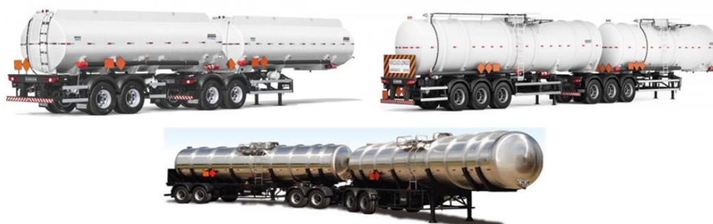
Figura 50 - Implementos rodoviários de grande capacidade usados no transporte de grânéis líquidos do tipo: Bitrem (sete eixos), Bitrem (nove eixos) e Rodotrem (nove eixos)
