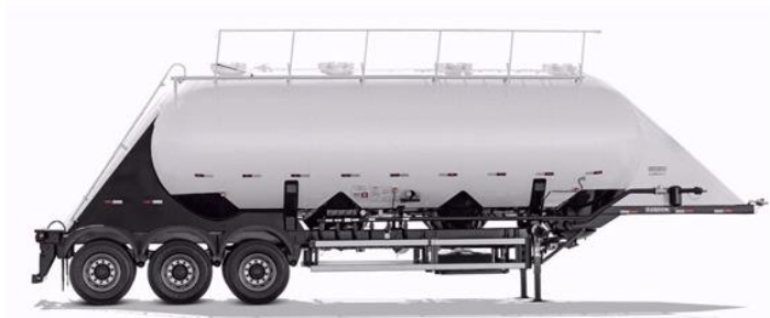
Figura 41 - Carroceria Silo utilizada para o transporte de cimento
