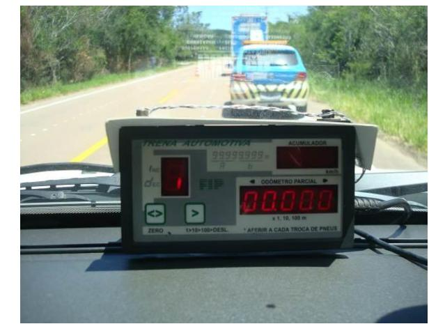
Figura 13 - Automóvel Equipado para o LVC-DNIT
