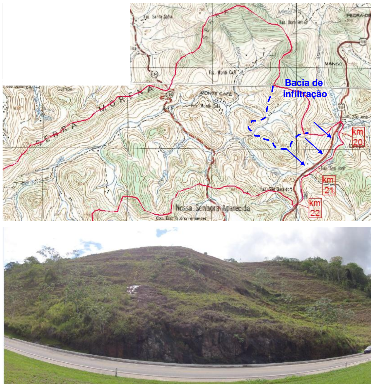
Figura 24 – Características morfológicas e geológicas da bacia do córrego Monte Café, afluente do rio São Francisco. Destaca-se em linha azul pontilhada o fundo de vale a montante (cota superior) da plataforma rodoviária, cuja baixa declividade favorece o acúmulo de água e, por consequência, infiltração de água no maciço composto por solo e rocha. Pontos de surgência de água no contato solo-rocha e nas fraturas do afloramento rochoso recoberto (km 20+185).
