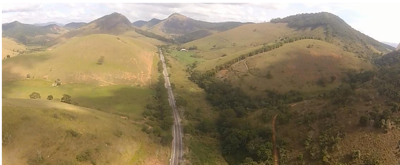
Figura 21 – Características morfométricas da bacia do córrego do Cortiço e faixa de influência predominantemente em planície de vales fluviais compostos de sedimentos. Corpos de aterro sobre solo aluvionar e aterros a meia encosta com saias em contato com a planície sedimentar (km 10+355).
