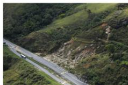
Figura 56 – Ruptura decorrente de alívio de tensões associado a pressões de água subterrâneas. Após o alívio de tensões, o campo de tensão que ocorre ao longo de anos, ganha uma proporção - movimentação de encosta com velocidades e deslocamentos elevados, que ocorrem desde a superfície do terreno até em profundidade superior a 30m dentro do horizonte rochoso (km 29+092).
