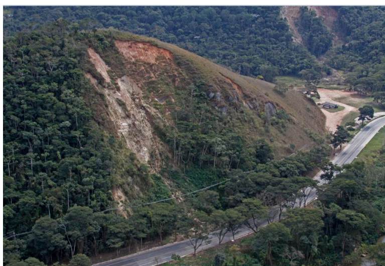
Figura 43 – Sub-segmento maciço 2 (km 65+800 ao km 66+600): morro residual convexo com presença de língua de tálus-colúvio no sopé do afloramento rochoso. Sub-segmento maciço 1 (km 64+925 ao km 65+800): presença de depósito de páleo-tálus-colúvio no sopé do afloramento rochoso situado entre terrenos de pacote espesso de solo residual. Depósito de páleo-tálus-colúvio Nos pacotes espessos de solo a ruptura assume maior porte e, normalmente, ocorre na interface dos materiais de diferentes propriedades mecânicas e hidráulicas.
