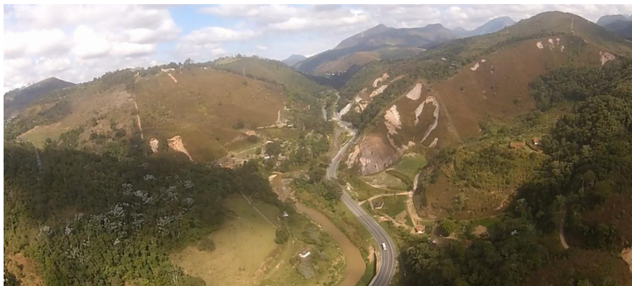
Figura 40 – Bacia hidrográfica do ribeirão dos Andradas limitada pelo divisor de águas dos contrafortes da Serra do Taquaruçu e pelo rio Paquequer. Segmento Andradas é influenciado pelo sistema de drenagem. O vale do rio Paquequer é fechado e encaixado em “V” formado por vertentes residuais, com predomínio de material de granulometria grosseira. No segmento Andradas o rio Paquequer se apresenta sinuoso com vale encaixado em “V” formado por vertentes residuais, com manto de alteração evoluindo de alteração e afloramentos rochosos para solo de granulometria mais grosseira, com predominância de silte arenoso pouco argiloso.
