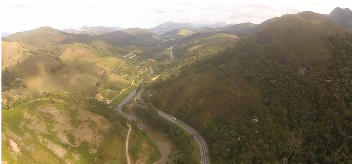
Figura 38 – Segmento geológico-geotécnico Ponte Nova é constituído de um único morro situado na pista 1 (lado direito). No lado esquerdo o talude de aterro ou natural pertence à margem esquerda do rio Preto que se desenvolve com geometria pouco sinuosa, que por vezes se aproxima da base do talude da plataforma rodoviária. Depósitos de tálus-colúvio em sopé de soerguimentos rochosos.
