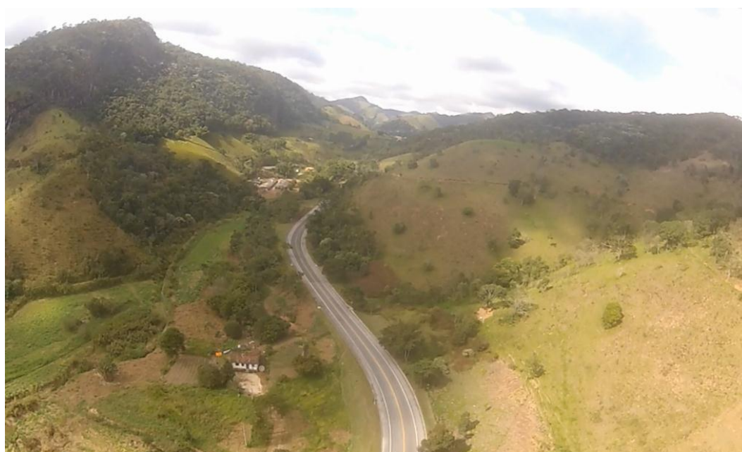
Figura 31 – Morfologia do relevo do segmento geológico-geotécnico Volta do Pião. Segmento em seção meia encosta com morro convexos (LD, pista 1) e taludes de aterro ou natural para o lado esquerdo (pista 2).
