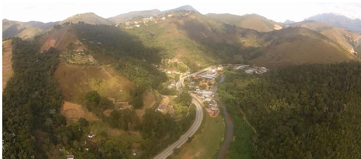
Figura 46 – Relevo do segmento geológico-geotécnico Poço do Peixe. Perímetro urbano com edificações para os dois lados. Rio Paquequer passa afastado da rodovia. Encostas compostas por solo residual com eventuais afloramentos rochosos nas bases dos taludes.
