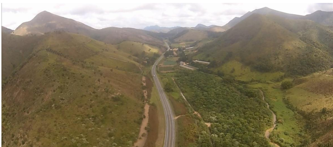
Figura 33 – Visão aérea da configuração do relevo do segmento do Capim - domínio de morros convexos-côncavos residuais, com ocorrência de serras, compartimentos colinosos em seções alveolares do rio do Capim e terraços com deposições aluvionares nas partes mais aberta do vale. Terraços com deposições aluvionares (lado direito da rodovia) situados entre domínio de colinas e morros (fotos no sentido crescente da quilometragem e no sentido do fluxo de água do rio Capim). Destacam-se alguns meandros na calha fluvial do rio Capim.
