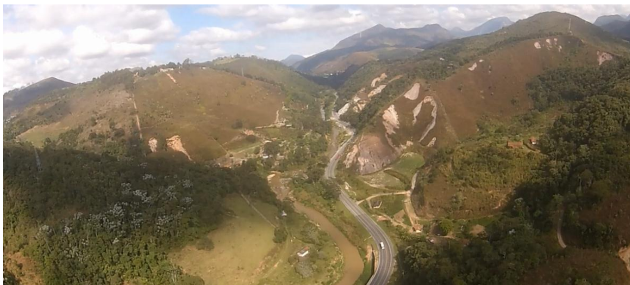
Figura 127 – No segmento Andradas o rio Paquequer se apresenta sinuoso com vale encaixado em “V” formado por vertentes residuais, com manto de alteração evoluindo de alteração e afloramentos rochosos para solo de granulometria mais grosseira, com predominância de silte arenoso pouco argiloso (Figura 127).
