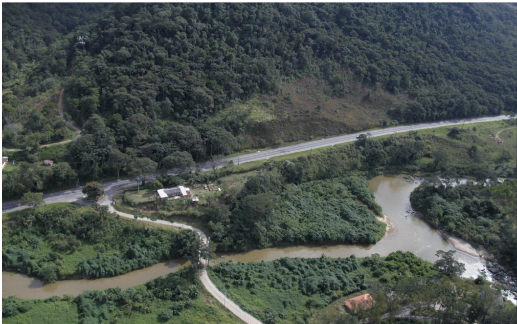
Figura 120 – Encontro dos rios Paquequer e Preto com direção perpendicular ao eixo da rodovia, cujo pé do talude é interceptado e, por consequência, solicitado pela curvatura externa da calha fluvial.
