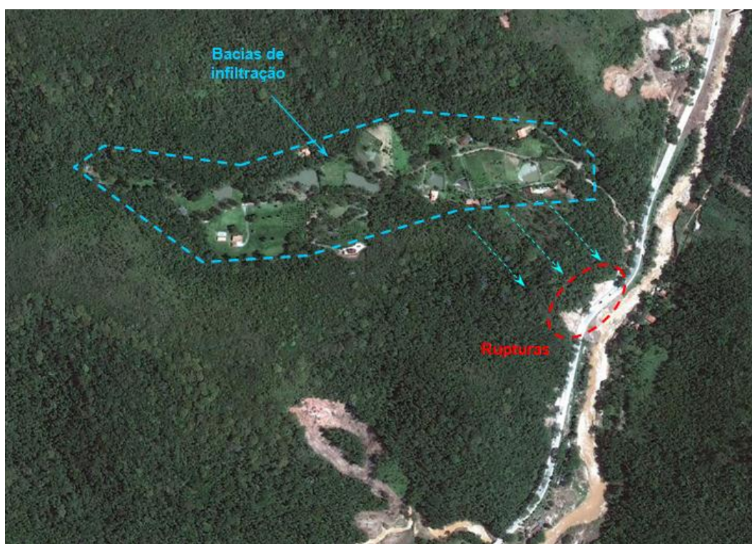
Figura 131 – Fontes de infiltração de água oriundas de represas implantadas a montante do talude.
