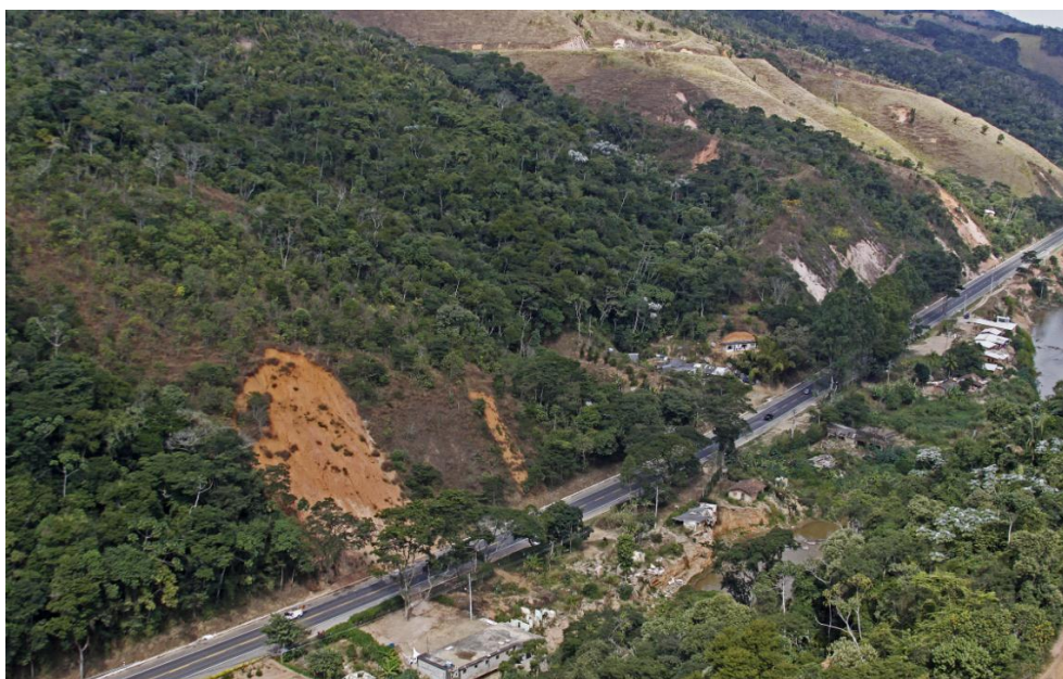
Figura 110 – Diversas rupturas mobilizadas nas encostas situadas na margem direita do rio Preto. Predominam os escorregamentos translacionais.
