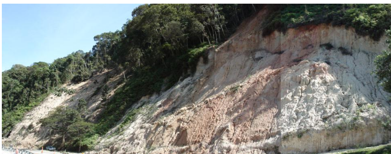
Figura 132 – Escorregamento translacional mobilizado pela associação do perfil geotécnico da encosta com elevadas pressões de água na interface de materiais com diferentes propriedades hidráulica e mecânica.
