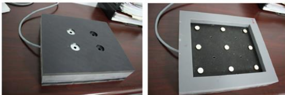
Figura 28 - Protótipo de Coleta de Energia (PEH) testado em trecho experimental
