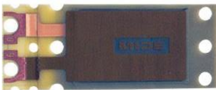
Figura 41 - Elemento piezoelétrico PPA-1014
