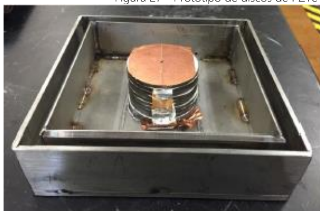
Figura 27 - Protótipo de discos de PZTe caixa de proteção para aplicação
