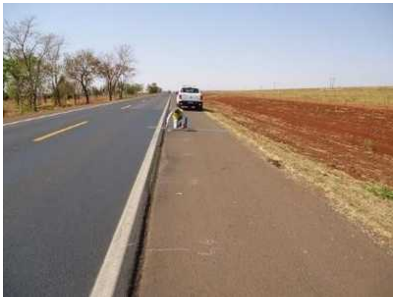
Figura 7: Exemplo de medição com régua de 3 metros no km 111+740 leste, em 10/09/2020 às 10:23
