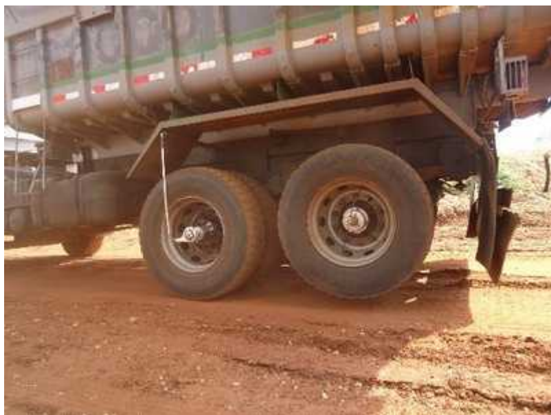
Figura 69: PP6 e demais - Scanner de eixos com inconsistência. Durante o funcionamento do sistema da praça foi observado que o para-lama do caminhão foi considerado como eixo suspenso
