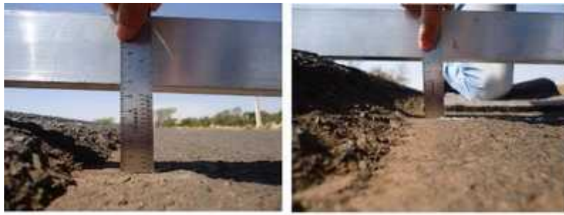
Figura 8: Exemplos de localidades com desnível entre pista e acostamento acima de 5 cm
