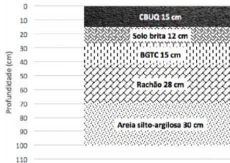
Estrutura de Pavimento n. 5: Sondagem BR-116, km 514,078, Faixa 2, Sentido Sul
