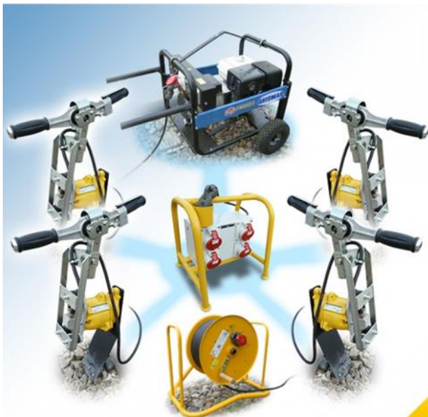
Figura 11: Conjunto de socaria manual, com vibradores e grupo motor/gerador (2,8 kW)
