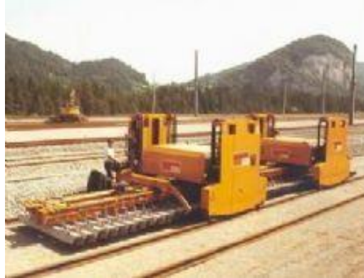
Figura 51: Pórtico telescópico de colocação e renovação de via (55 kW)
