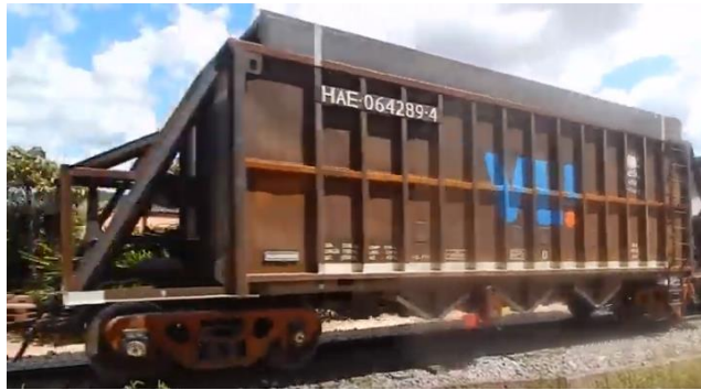
Figura 64: Vagão hopper aberto com descarga manual, HAE, capacidade de 77 t / 45 m 3 - Bitola Métrica
