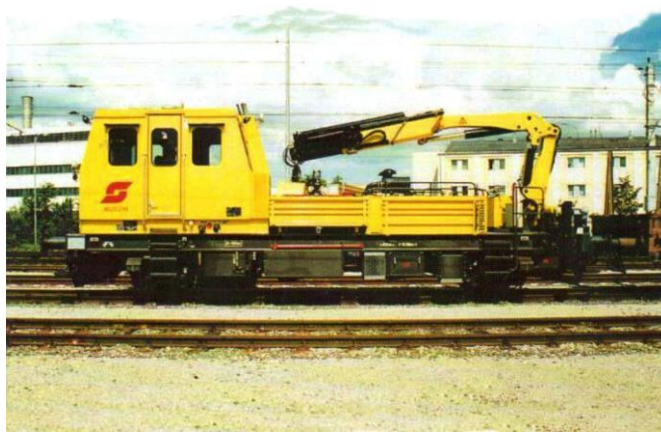
Figura 4: Caminhão de linha ferroviário com guindauto e vagonetas (367 kW)
