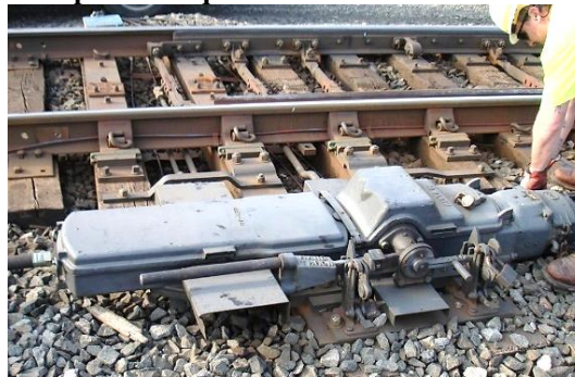
Figura 225: Exemplo de máquina de chave eletro-hidráulica, modelo 5A
