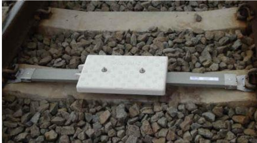
Figura 295: Exemplo de radar doppler de subestrado para CBTC
