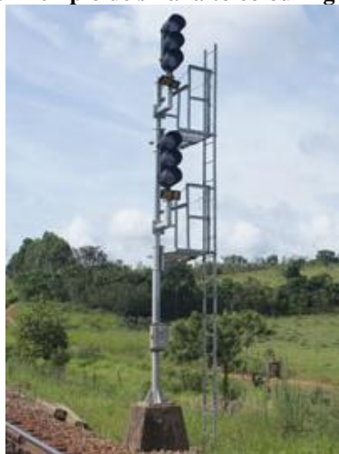
Figura 320: Exemplo de sinal alto colour light multifocal
