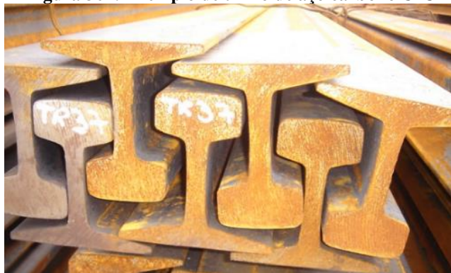
Figura 364: Exemplo de trilho de aço carbono UIC
